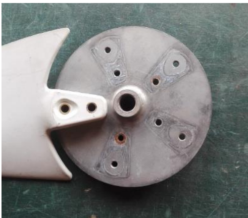
Montage plaat voor de wieken. Nu geschikt voor 5 bladen, maar kan aangepast naar 3 of 2
